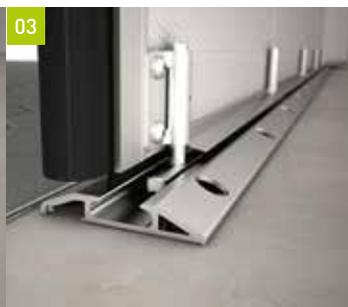
**[03]** Ce rail de guidage est idéal dans le cadre de travaux de rénovation. En raison de sa faible hauteur (15 mm), il peut être monté directement sur le sol fini et il n'est pas nécessaire de se lancer dans des travaux de maçonnerie compliqués. Par ailleurs, cette faible hauteur ne constitue absolument aucun obstacle au franchissement.
